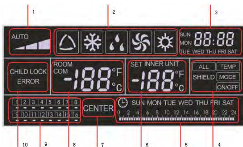
Obr. 2.2: Význam symbolů na LCD displeji
